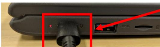
電源ボタンが点灯しない場合は、左横の USB-C に充電ケーブルを接続し、しばらく充電後再度電源を入れてください。(充電中は赤ランプが点灯します)
